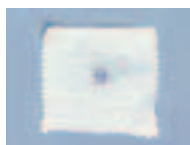
パールトーン未処理 水を含んで縮んでいる。
